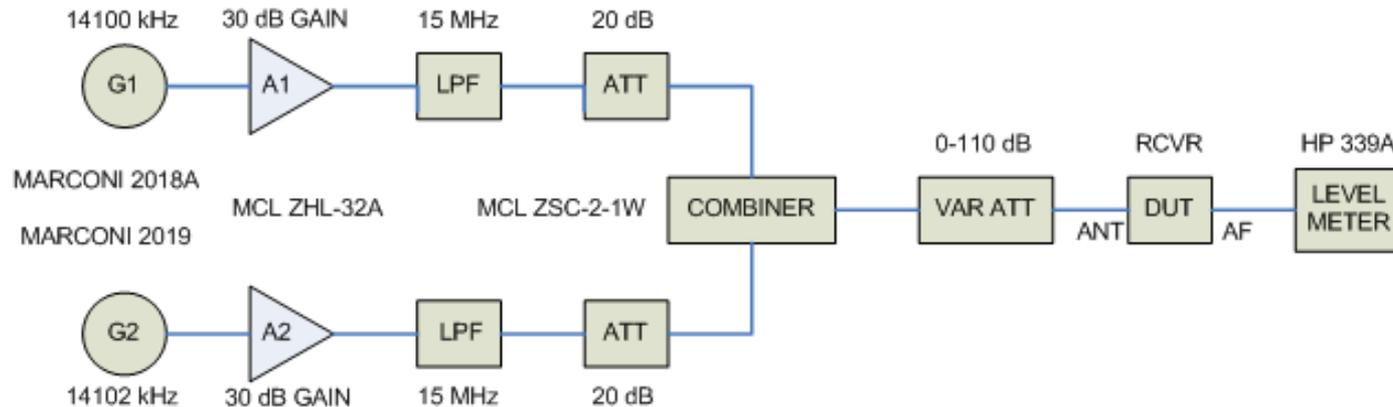
BLOCK DIAGRAM OF TYPICAL TWO-TONE RECEIVER TEST SETUP
